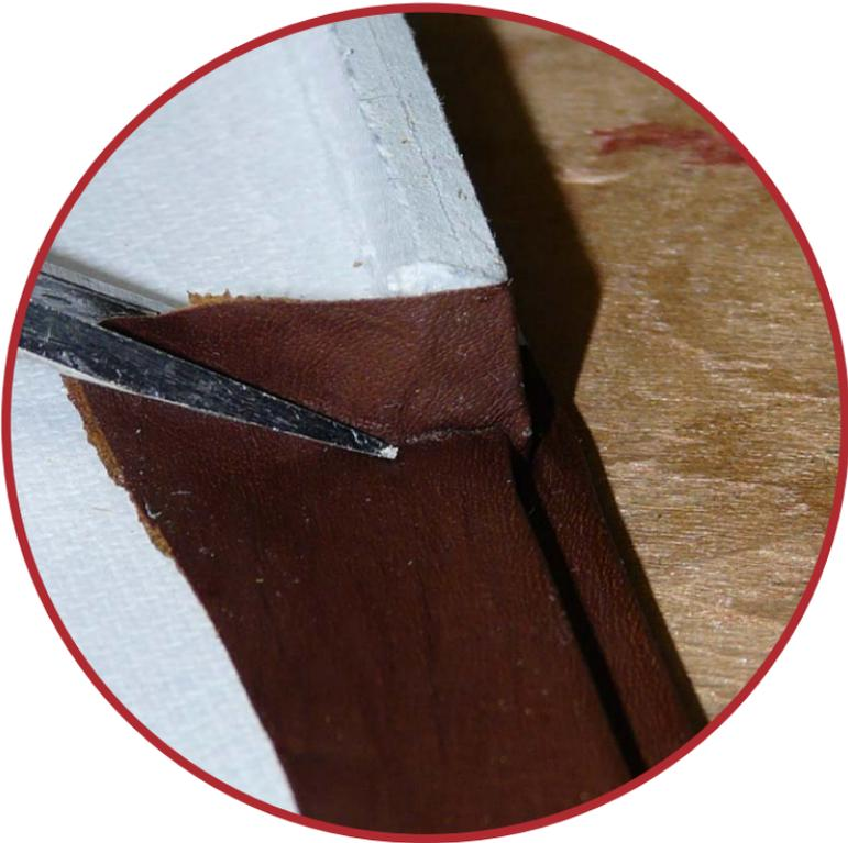
*Beim Einschneiden des Leders an den Ecken der Innenkanten, wo die Stützen enden. Der genaue Ort ist aus der Abbildung auf der linken Seite zu erkennen.*
